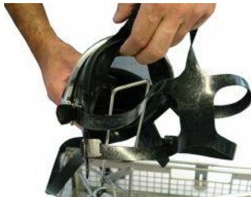
Sicherung anheben, Innenmaske auf Bügel setzen und sichern.
