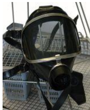
Maske am oberen Dichtrand auf Bügel einhängen.
