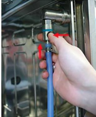
Arretierknopf betätigen um die Druckluftleitung zu entkoppeln.
