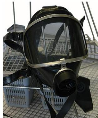
Maske am oberen Dichtrand auf Bügel einhängen.
