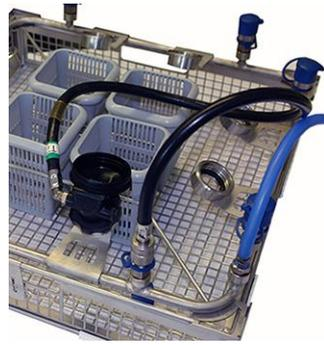
Lungenautomat aufschrauben, ausrichten und Druckluftleitung anschließen.
