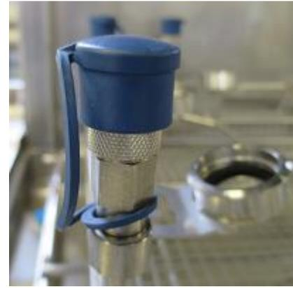
Les raccords non utilisés doivent être fermés avec le bouchon de protection avant chaque cycle de nettoyage.
