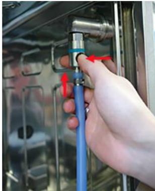
Appuyer sur le bouton de verrouillage pour découpler la conduite d'air comprimé.
