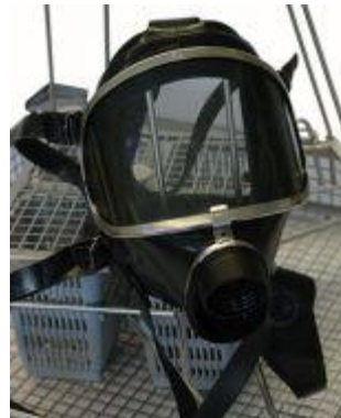
Masker aan de bovenste afdichtrand op de beugel hangen.
