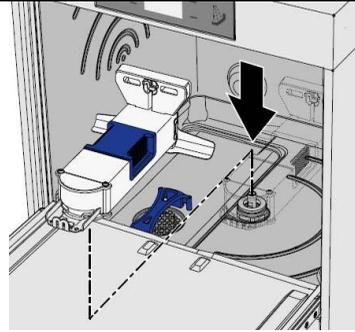
2. Colocar el adaptador para cestas de botellas en el cubo del brazo de lavado.
