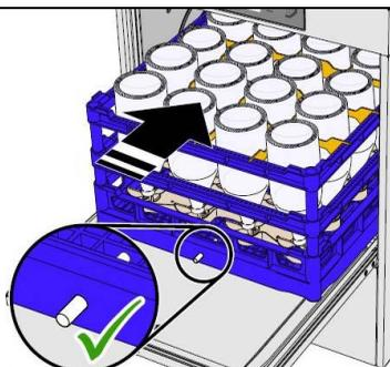
5. Potisnite košaro za steklenice v pomivalni stroj. Čep mora kazati v smeri naprej.
