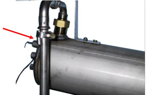
Temperaturfühler (saugseitig) am Trocknungsgebläse.
