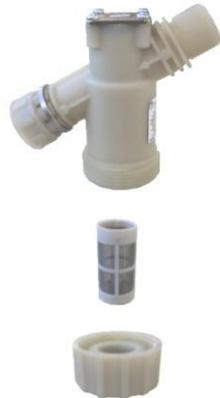
Eine Reinigung des Schmutzsiebes ist ohne Absperrn des bauseitigen Wassernetzes möglich. Durch Abschrauben des Unterteils, in dem sich der Schmutzsieb befindet, wird automatisch der Wasserzufluss gesperrt. Dadurch kann problemlos der Schmutzsieb zur Wartung gereinigt werden.
