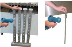
Reinigen Sie Die Wasch- + Klarspülarms und deren Düsen. Zum Reinigen der Düsen, benutzen Sie eine Nylon Bürste. Überprüfen Sie die Wascharms und Endkappen auf Vollständigkeit und Dichtheit.
