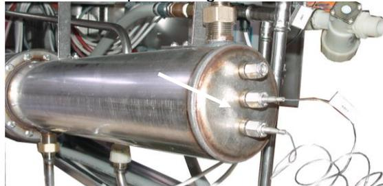
Sicherheitstemperaturbegrenzer am Trocknungs-Heizregister:
