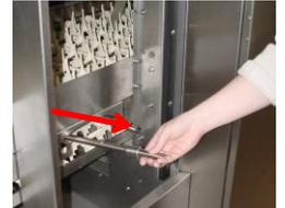
Entfernen Sie alle Verkleidungen im Einlauf- und Auslaufbereich
