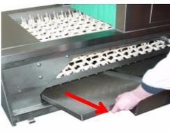
Entfernen Sie die Siebe. Reinigen Sie den gesamten Einlauf- und Auslaufbereich mit einem Wasserschlauch.
