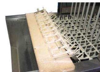
Das Bandstück wird soweit in die Maschine geschoben, bis sich das Ende kurz vor dem Einlauffunnel befindet.
