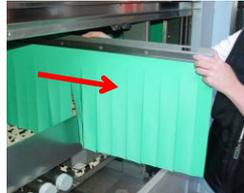
Entfernen Sie alle Spritzschutzhänge, und reinigen Sie diese.
