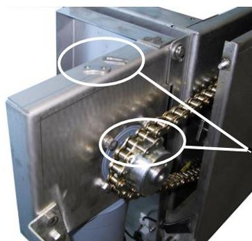
Wenn das obere und untere Trum der Antriebskette auf das Antriebskettenrad gelegt wird kann problemlos das Kettenschloss eingesetzt werden.
