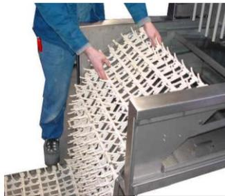
Der Bandanfang, (die Seite des Bandes in der sich die Bandstange befindet) wird von der Einlaufseite der Maschine auf die Laufschienen geschoben.
