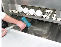
Reinigen Sie den Tankinnenraum mit einem Wasserschlauch.
