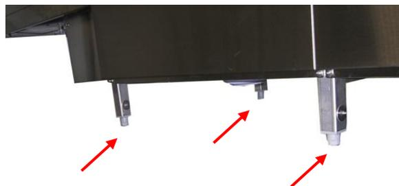
Zur Verstellung der Maschinenstollen ist ein Schraubenschlüssel der Schlüsselweite SW 27 notwendig!
