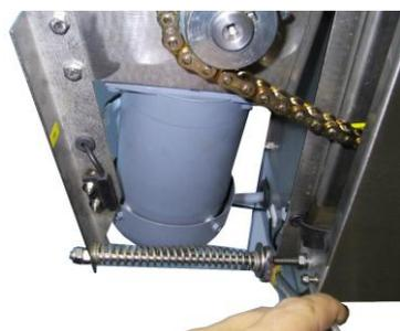
Nachdem die Kette des Antriebmotors montiert ist, muss die Überlastabschaltung des Transportbandes eingestellt werden.
