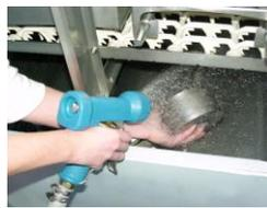
Entfernen Sie den Pumpenansaugsieb und reinigen Sie diesen.
