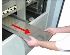
Entfernen Sie die Siebauflagen.
