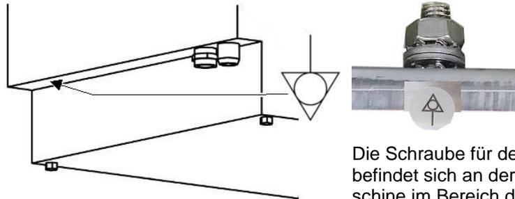
Die Schraube für den Potentialausgleich befindet sich an der Rückseite der Maschine im Bereich der Medienanschlüsse.
