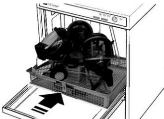
4. Korb in das Reinigungs- und Desinfektionsgerät einführen.
