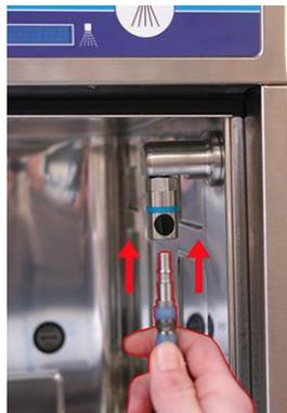
Druckluftschlauchanschluss in die Kupplung schieben.
