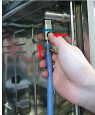
Arretierknopf betätigen um die Druckluftleitung zu entkoppeln.
