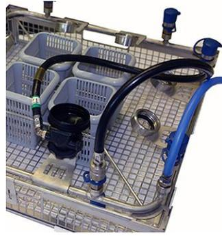
Lungenautomat aufschrauben, ausrichten und Druckluftleitung anschließen.
