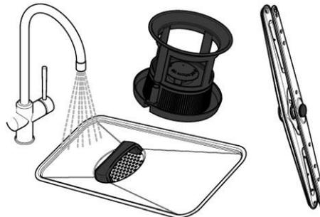
2. Tankabdecksieb, Filter, Waschsysteme oben und unten entnehmen. Alle zu reinigenden Teile sind blau oder haben einen blauen Griff.
