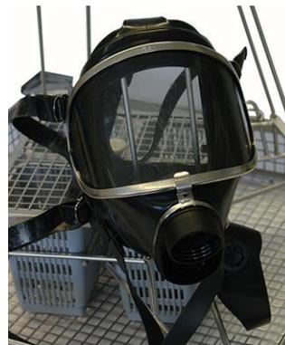
Maske am oberen Dichtrand auf Bügel einhängen.
