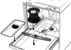
6. Filter, Tankabdecksieb und Waschsysteme einsetzen.
