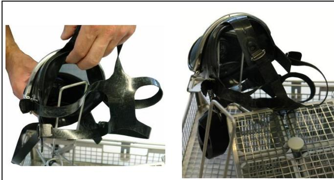
Suspendre le masque sur le bord d'étanchéité supérieur se trouvant sur la boucle.
