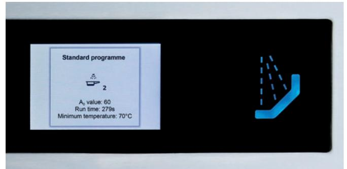
**Passaggio 4:** dopo un conto alla rovescia il programma si avvia automaticamente, il colore diventa verde.
