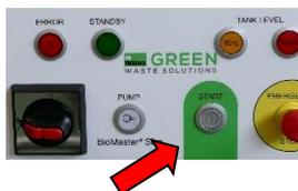
17. Drücken Sie den grünen Taster START. Der Zyklus läuft an. Nach Abschluss erlöschen die Taster START und PUMP. Der BioMaster®Slim schaltet automatisch ab.
