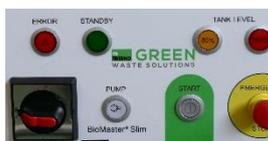
21. Drücken Sie den weißen Taster PUMP. Halten Sie ihn gedrückt, bis der Trichter ganz vollständig entleert ist.
