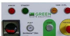
2. Drücken Sie den weißen Taster PUMP. Halten Sie ihn gedrückt, bis der Trichter vollständig entleert ist.
