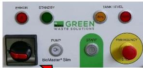
8. Drücken Sie den weißen Taster PUMP. Halten Sie ihn gedrückt, bis der Trichter vollständig entleert ist.
