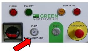
1. Drücken Sie den weißen Taster PUMP. Halten Sie ihn gedrückt, bis der Trichter vollständig entleert ist.
