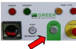
17. Appuyez sur le bouton vert START. Le cycle de broyage démarre. Lorsque le cycle de broyage est terminé, les boutons START et PUMP s'éteignent. Le BioMaster® Slim s'arrête automatiquement.
