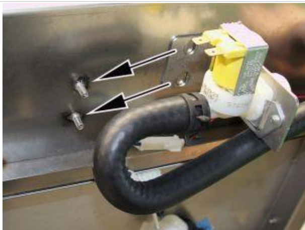
9. Das Magnetventil auf der Rückseite anbringen und die Gewindebolzen durch die Löcher des Winkels führen.
