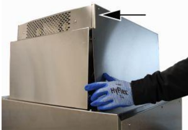
18. Die Rückwand oben einhaken und mit 8 Blechschrauben befestigen.
