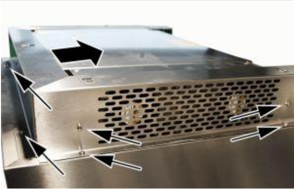
17. Das Gehäuse der Lüftereinheit von der Vorderseite einschieben. Das Gehäuse mit 4 Blechschrauben pro Seite und 2 Blechschrauben auf der Vorderseite befestigen.
