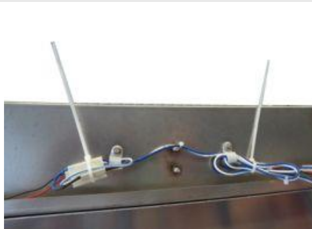
12. Die Kabel entsprechend der Kabellänge an der Maschine verlegen und mit den beiliegenden Klemmen befestigen.
