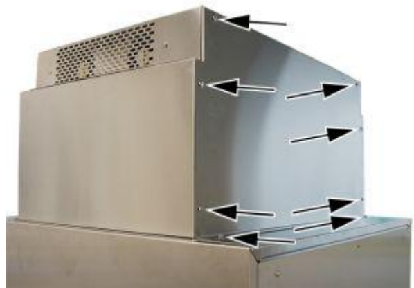
18. Die Rückwand oben einhaken und mit 8 Blechschrauben befestigen.
