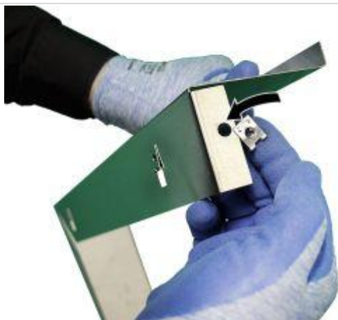
16. Die 7 Clips auf die Löcher des Gehäuses für die Lüftereinheit schieben.
