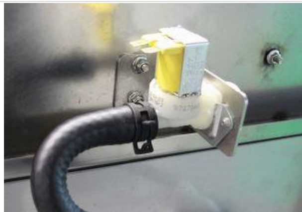
10. Das Magnetventil mit 2 Sicherheitsmuttern M5 befestigen.
