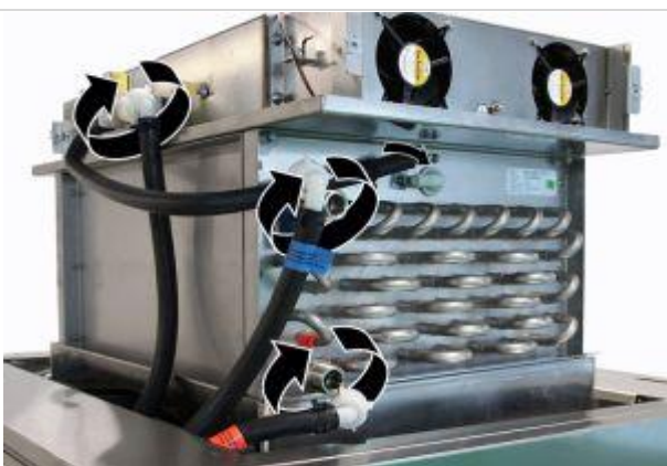
11. Die Schläuche anschließen und handfest andrehen. Den oberen Schlauch auf der Vorderseite mit einer Federbandschelle befestigen. Beim Montieren der Schläuche auf die Farbmarkierungen achten.
