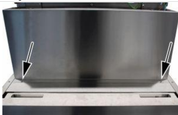
15. Das Gehäuse der Wärmetauschereinheit auf der Vorderseite mit 2 Blechschrauben befestigen.
