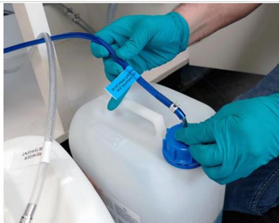
5. Raccorder le tuyau bleu à la lance d'aspiration dans le bidon bleu réservé au produit de rinçage. Serrer l'attache au niveau du raccordement.
