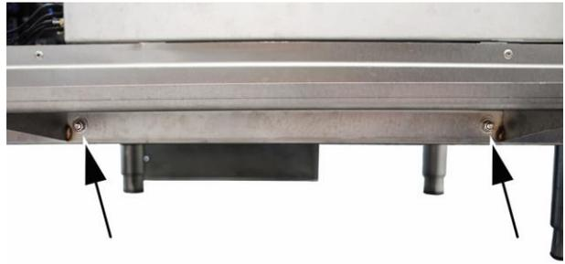
12. Visser le socle avec 2 rondelles et des écrous autobloquants M6.
