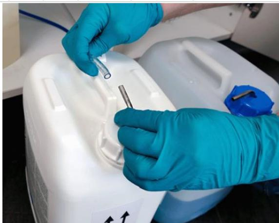
4. Raccorder le tuyau transparent à la lance d'aspiration dans le bidon blanc réservé au détergent. Pour le fixer, comprimer l'attache au niveau du raccordement et la relâcher dans la position correcte.
