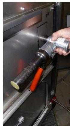
3. Placer la plaque rectangulaire sur le panneau latéral. Pour retirer facilement la plaque, percer un trou de  $\text{Ø } 8 \text{ mm}$  dans chaque coin.
