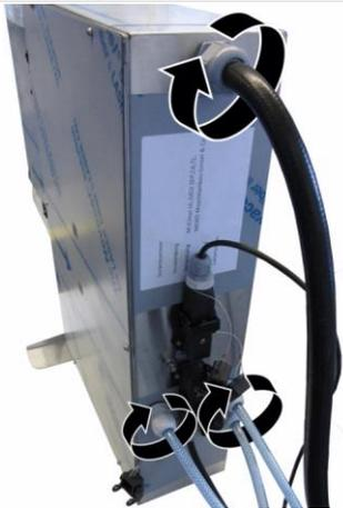
11. Serrer les tuyaux de l'extérieur et poser le recouvrement.
