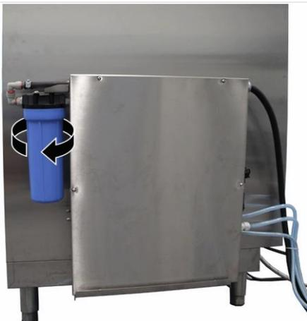
18. Insérer l'élément filtrant et visser le préfiltre à la main.
