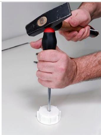
2. Percer un trou au milieu de chaque couvercle du bidon de détergent et du produit de rinçage.
