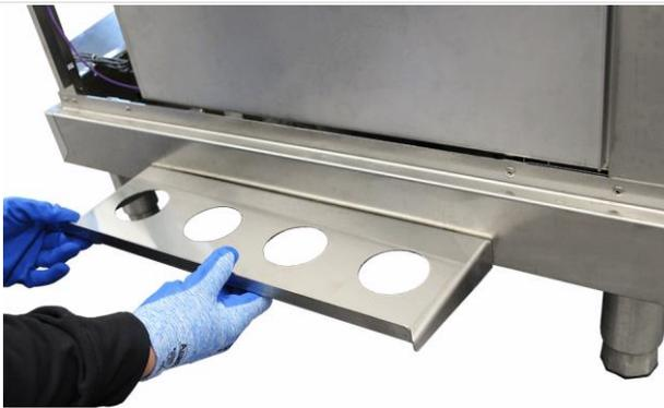
11. Poser le socle et glisser les vis à tête hexagonale dans les trous du socle.
