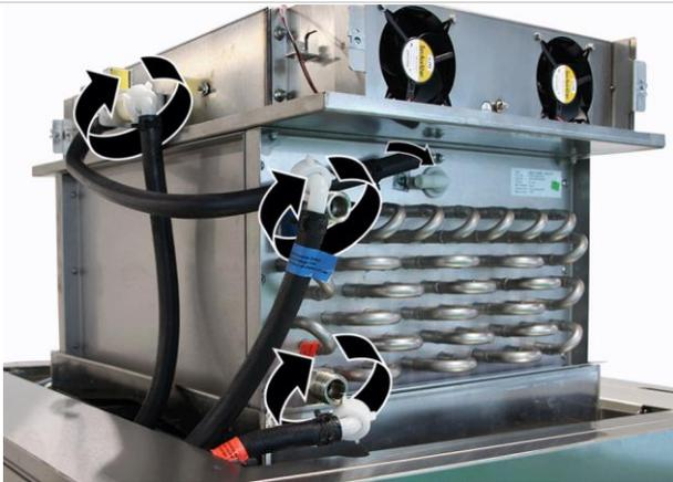
11. Raccorder les tuyaux et les serrer à la main. Fixer le tuyau supérieur à l'avant à l'aide d'un collier de serrage à ressort. Lors du montage des tuyaux, faire attention aux repères de couleur.
