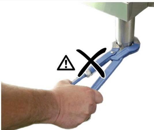
2. Délester le pied et le régler à la hauteur souhaitée à l'aide d'une clé à fourche adaptée. Ne pas utiliser de pince !
