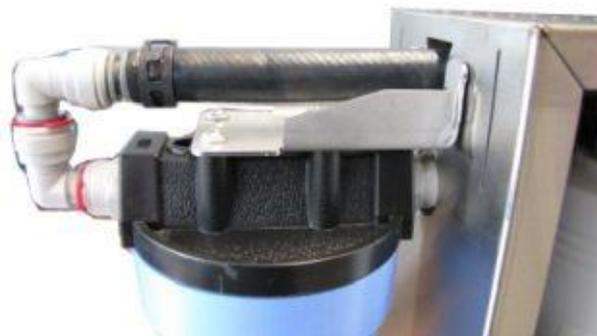
4. Raccorder le réseau d'alimentation d'eau au pré-filtre à l'aide d'un collier de serrage à ressort et relier la fiche de raccordement coudée.
