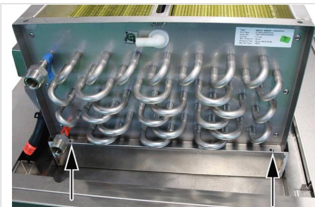
1. Placer l'échangeur thermique sur le lave-vaisselle et faire passer les boulons filetés du lave-vaisselle à travers les trous de l'échangeur thermique. Positionner les raccords pour les tuyaux sur le côté gauche.
