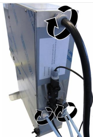
8. Draai de slangen aan de buitenkant vast en bevestig de afdekking.
