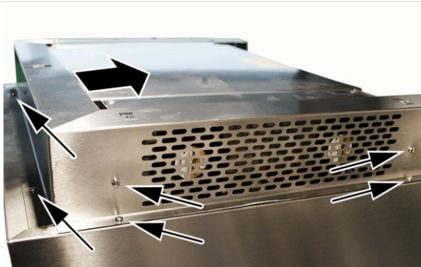
17. Schuif de behuizing van de ventilatoreenheid er vanaf de voorkant in. Zet de behuizing vast met 4 zelftappende schroeven per zijde en 2 zelftappende schroeven aan de voorkant.
