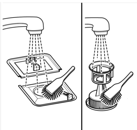
11. Tankabdecksiebe und Filter reinigen.
