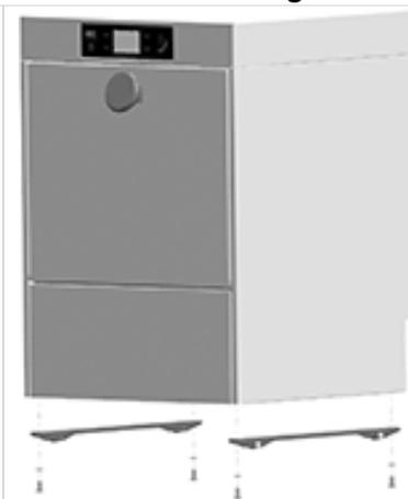
Die Maschinenfüße (4x) entfernen und die beiden Rollensockel jeweils mit 2 Federring und 2 Sechskantschrauben M8 befestigen.
