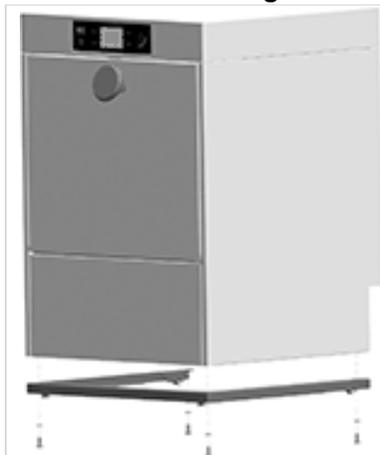
Die Maschinenfüße (4x) entfernen und den Rollensockel mit Federring und Sechskantschraube M8 befestigen (4x).
