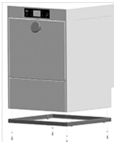
Die Maschinenfüße (4x) entfernen und den Leersockel mit Federscheibe und Sechskantschraube M8 befestigen (4x).
