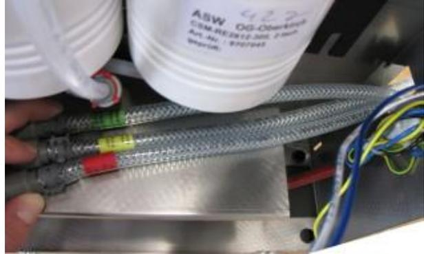
1. Klarsicht-Gewebesschläuche (Permeat, Permeatrückführung, Konzentrat) durch die seitliche Öffnung im Gehäuse führen.
