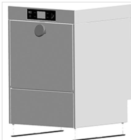
Die Schutzfolie am Klebepad der Gleitschiene entfernen und die Gleitschiene über die Vertiefungen an den Gestellfüßen ausrichten und aufkleben.
