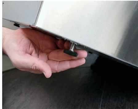
2. Die Sechskantschraube mit dem Kunststoffring auf die gewünschte Länge herausdrehen. Bei den anderen 3 Maschinenfüßen die Vorgehensweise wiederholen.
