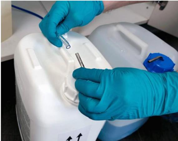
7. Den transparenten Schlauch mit der Saugglanze im weißen Kanister für Reiniger verbinden.
