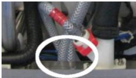
1. Die Klarsicht-Gewebesläuche durch die Öffnung in der Quertraverse führen und gemäß Anschlusssituation mit dem Freien Auslauf verbinden, siehe Seite 14. Anschließend mit Kabelbindern an den Laschen befestigen (Zugentlastung).
