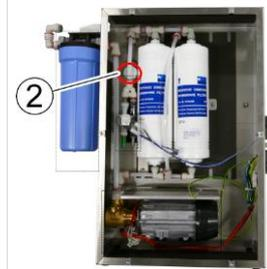
Die Drossel (1) befindet bei allen drei Varianten des GiO-MODULS in der Nähe des Schmutzfängers (2).
