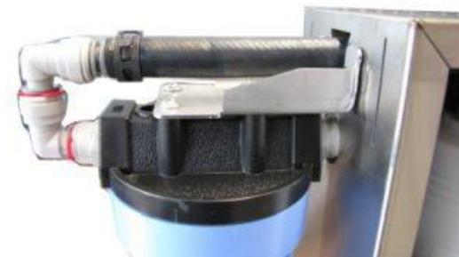
5. Schlauch mit Federbandschelle befestigen und Steckverbindungsbogen verbinden.
