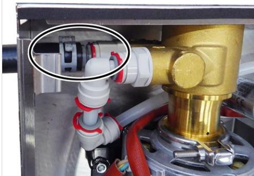
3. Den Schlauch an den freien Anschluss am Pumpengehäuse stecken und mit Sicherungsring fixieren.
