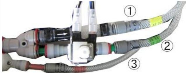
2. Permeat-Rückführleitung (1), Permeatleitung (2) und Konzentratleitung (3) entsprechend der farblichen Kennzeichnung mit den Anschlüssen verbinden und mit Sicherungsringen fixieren.
