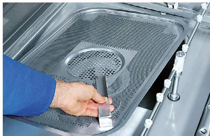
Tankafdekzeef Gerichte restenafvoer in het AktivPlus fijnfilter. Stoffer-en-blik-effect zorgt ervoor dat grof vuil eenvoudig wordt verwijderd.
