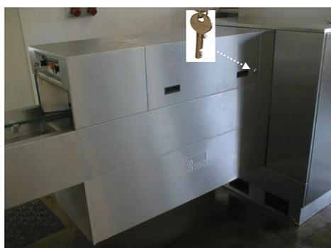
La trappe de tunnel ne peut être ouverte qu'avec une clé. Seules les personnes instruites sont habilitées à ouvrir la trappe de tunnel. Cela peut s'avérer nécessaire lors d'un déclenchement du système d'autosurveillance de l'installation. En cas de danger, il convient d'actionner l'arrêt du transport (voir Figure 10.2.1). Le convoyeur vertical est équipé d'un ARRÊT D'URGENCE (voir Figure 10.2.3 Position 1). Après l'élimination de la cause de la désactivation, la trappe doit être refermée à clé.
