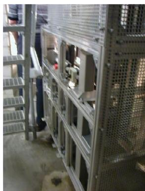
L'habillage en tôle perforée du convoyeur vertical protège contre les accidents.
