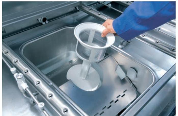
**Sistema *AktivPlus* per il filtraggio dell'acqua di lavaggio**
