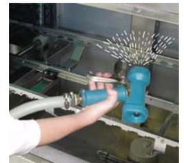
Reinigen Sie den kompletten Tankinnenraum mit einem Wasserschlauch
