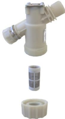
Eine Reinigung des Schmutzsiebes ist ohne Absperren des bauseitigen Wassernetzes möglich. Durch Abschrauben des Unterteils, in dem sich der Schmutzsieb befindet, wird automatisch der Wasserzufluss gesperrt. Dadurch kann problemlos der Schmutzsieb zur Wartung gereinigt werden.
