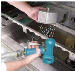
Reinigen Sie das Pumpensieb.
