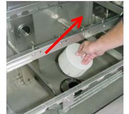
Entfernen Sie das Pumpenansaugsieb.
