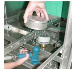
Reinigen Sie das Pumpensieb.
