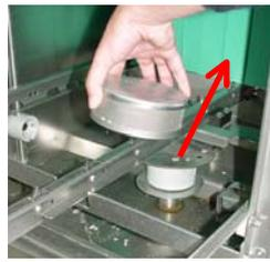
Entfernen Sie das Pumpenansaugsieb
