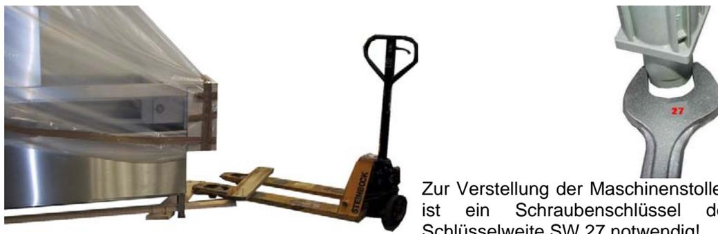
Zur Verstellung der Maschinenstollen ist ein Schraubenschlüssel der Schlüsselweite SW 27 notwendig!
