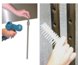
Limpie los brazos de lavado y aclarado y sus pulverizadores. Utilice cepillos de nylon. Compruebe que los tapones de los brazos están en su sitio y estancos.
