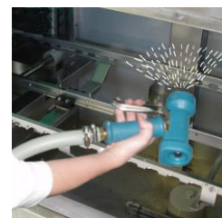
Limpie toda la cámara interior del tanque empleando para ello una manguera.
