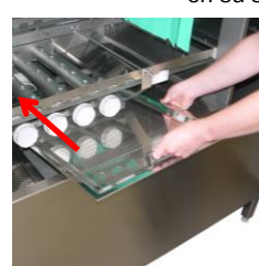
Limpie los brazos de lavado y aclarado y sus pulverizadores. Utilice cepillos de nylon. Compruebe que los tapones de los brazos están en su sitio y estancos.
