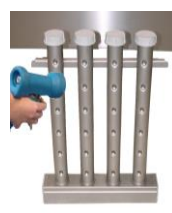
Limpie los brazos de lavado y aclarado y sus pulverizadores. Utilice cepillos de nylon. Compruebe que los tapones de los brazos están en su sitio y estancos.
