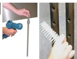
Nettoyez les tuyaux de lavage et de rinçage final a pompe et leurs gicleurs. Utilisez une brosse en nylon pour nettoyer les gicleurs. Vérifiez l'intégralité et l'étanchéité des tuyaux de lavage et des capuchons d'extrémité.
