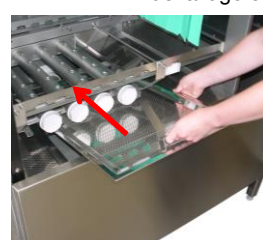
Nettoyez les tuyaux de lavage et de rinçage final a pompe et leurs gicleurs. Utilisez une brosse en nylon pour nettoyer les gicleurs. Vérifiez l'intégralité et l'étanchéité des tuyaux de lavage et des capuchons d'extrémité.
