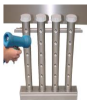
Nettoyez les tuyaux de lavage et de rinçage final a pompe et leurs gicleurs. Utilisez une brosse en nylon pour nettoyer les gicleurs. Vérifiez l'intégralité et l'étanchéité des tuyaux de lavage et des capuchons d'extrémité.
