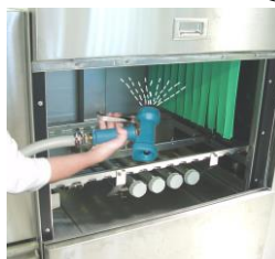
Aspergez l'intérieur de la machine et la partie arr. des portes hydrauliques avec un tuyau.
