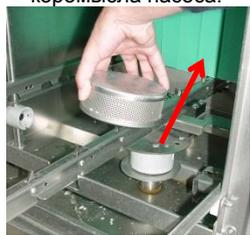
Снимите всасывающий сетчатый фильтр насоса.
