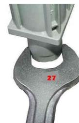
Для регулировки опор машины необходим гаечный ключ на 27 мм!
