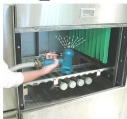
Вымойте водой из шланга внутреннее пространство машины и подъемную дверцу.
