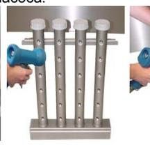
Очистите моющие трубки, ополаскивающие коромысла насоса, а также их форсунки. Для очистки форсунок используйте нейлоновую щетку. Проверьте комплектность и герметичность разбрызгивающих коромысел и концевых крышек.
