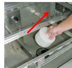
Снимите всасывающий сетчатый фильтр насоса.
