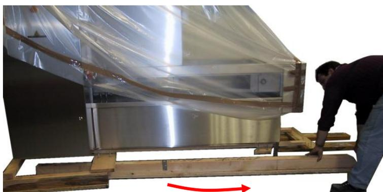
Теперь машину нужно снова опустить на пол. Убрать грузоподъемные тележки.
