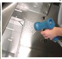
Промойте корпус поплавка системы контроля уровня воды
