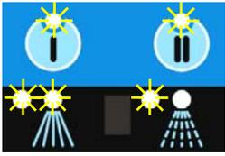
Mit der Taste "Übernehmen" Parameter zum Ändern bestätigen, die beiden LED's der Programmvorwahltasten blinken und der momentan eingestellte Wert wird durch die LED-Kombination von Boiler- und Tanktemperatur angezeigt. Die Wasserhärte kann von 8 bis 36 °dH eingestellt werden. Mit der Taste "I" den Wert erhöhen oder mit der Taste "II" verringern und mit der Taste "Übernehmen" speichern.
