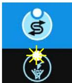
Das Aufleuchten der roten Lampe zeigt an, dass die Kapazität des Wasserenthärters weitgehend erschöpft ist. Bis zur vollständigen Erschöpfung können noch etwa 10 Programmabläufe durchgeführt werden.
