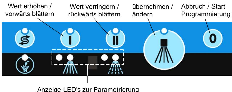
Zur Programmierung der Steuerung muss die Spannungsversorgung gewährleistet, sowie der Automat komplett ausgeschaltet sein (keine LED leuchtet).
