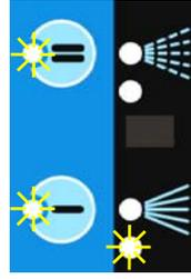
Hierzu wird die Taste "0" so lange gedrückt, bis beide LED's der Programmvorwahltasten leuchten (ca. 3 sec). In der Reihe der Tank- und Boiler-LED's leuchtet die linke LED und signalisiert dadurch den ersten veränderbaren Parameter.
