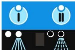
Die eingestellte Temperatur des Klarspülwassers wird innerhalb der vorgegebenen Zeit nicht erreicht. Die Ursache kann ein defekter Boilerheizkörper oder Boiler-temperaturfühler sein.
